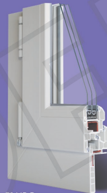
70 MD Reno Valeur U du cadre: 1.2 W/m 2 K* Verre jusqu'à Ug 0.6* Valeur U globale jusqu'à: 0.92 W/m 2 K*
