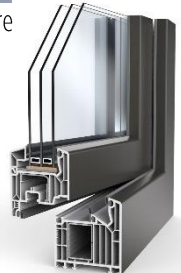
Veka Softline 82 mm, 3 Joints Système à 7 chambres Uf 1,0 W/(m 2 ·K)
