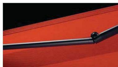
**ROBUSTESSE** La conception des bras des stores allie une grande robustesse et un design fin sans aspérités à la jonction des composants. Ils sont équipés d'une articulation haute résistance grâce à une bague bronze et des câbles acier surmoulés.
